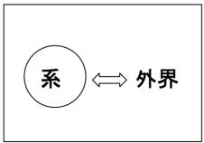
孤立系(閉じた系、閉鎖系):外界との間に質量、仕事、エネルギーの出入りがない系
